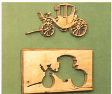
Calèche découpée dans du hêtre de 4 cm, découpe douce et sans bavures.
