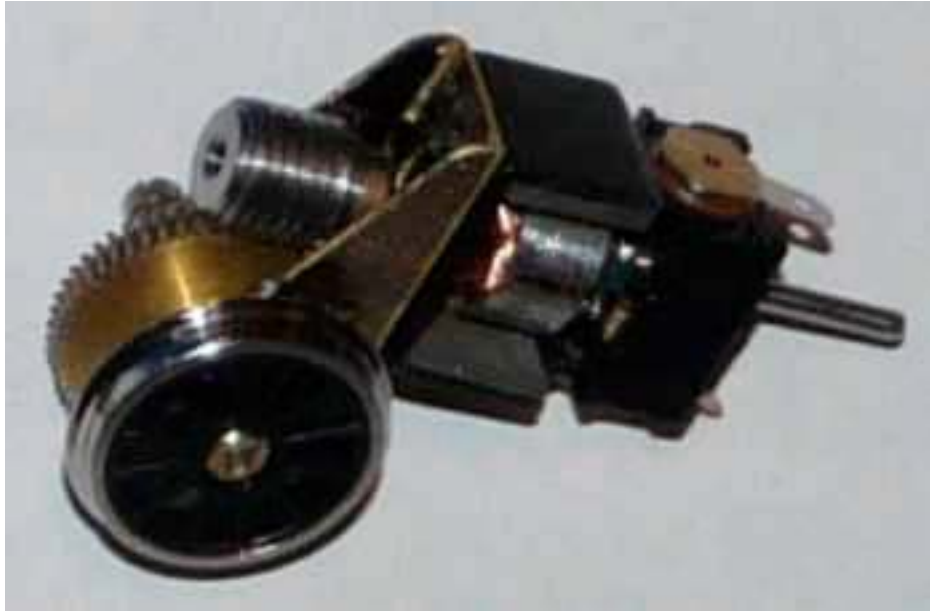
Moteur série H882 ou H883 monté sur le réducteur.
