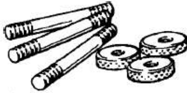
Fig3. Vis et écrous de fixation pour la C300. Les vis sont disponibles en quatre tailles différents pour s'adapter à des moules allant jusqu'à 6,35cm. Les vis les plus longues (vis C252 'D') sont longues de 8,26cm et est filetée jusqu'à 2,22cm. Vous pouvez ainsi la couper à la taille de votre choix.
